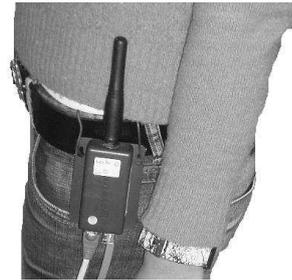
Fig. 2. PLACEMENT OF THE READER AT THE SIDE OF THE HUMAN BODY AT THE HIP LEVEL.
