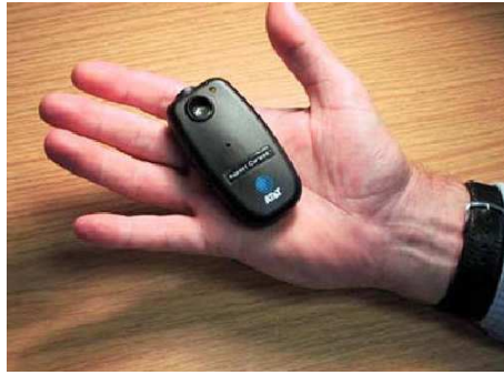
Figura 1: Dispositivo generador de señales ultrasónicas que se cuelga del cuello de una persona correspondiente al sistema de localización de AT&T 'Active Bat'
