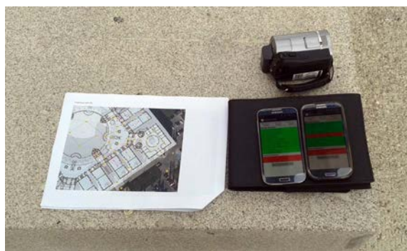
Figura 2: En los experimentos descritos en este trabajo, se recogieron las señales de oportunidad en varios recorridos por la Escuela Politécnica de la UAH mediante dos teléfonos móviles con un software especial. Además, las trayectorias se registraron en vídeo para referencia futura.
