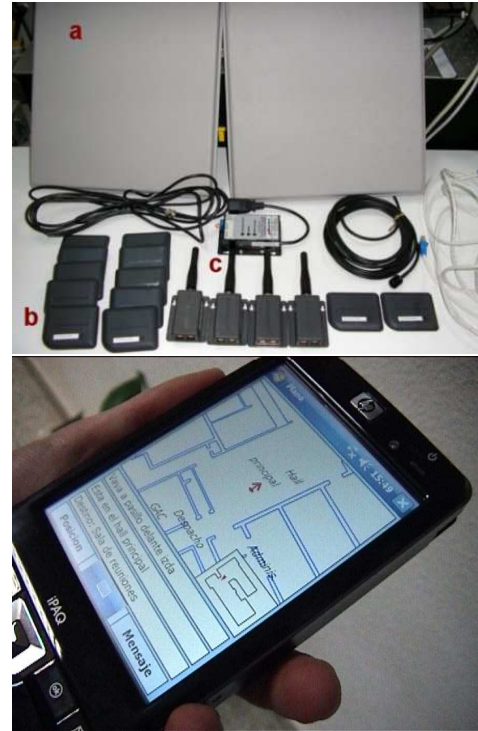
Figura 2: Parte superior: sistema RFID adquirido a la empresa Wavetrend: (a) antenas de tipo panel (direccionales); (b) marcadores (tags) activos; (c) antenas omnidireccionales con lector. Parte inferior: PDA iPAQ de HP con el sistema de localización basado en RFID en funcionamiento.
