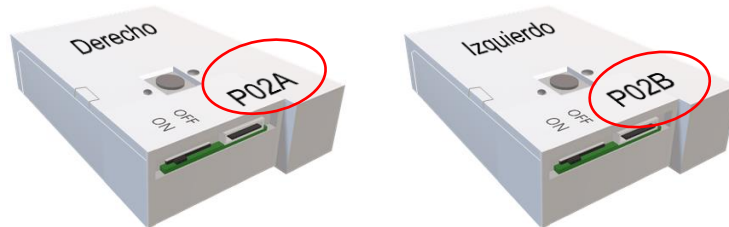
Figura 3: Pareja de IMUs (e.g. la pareja 02 etiquetada como P02). Siendo la letra final A o B indicativo de dónde deben ser colocadas (pie derecho e izquierdo, respectivamente).
