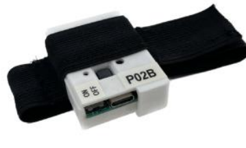
(b) Insertar IMU en banda elástica de sujeción
