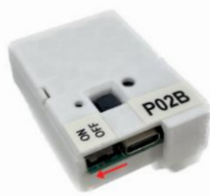
(a) Encender la IMU (Interruptor en ON)
